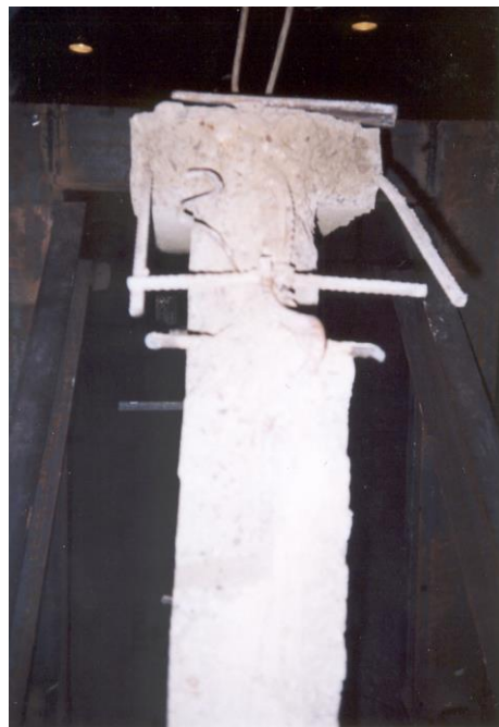
Рисунок 2.16 – Повреждения упорной части при одностороннем нагружении однослойного фрагмента
