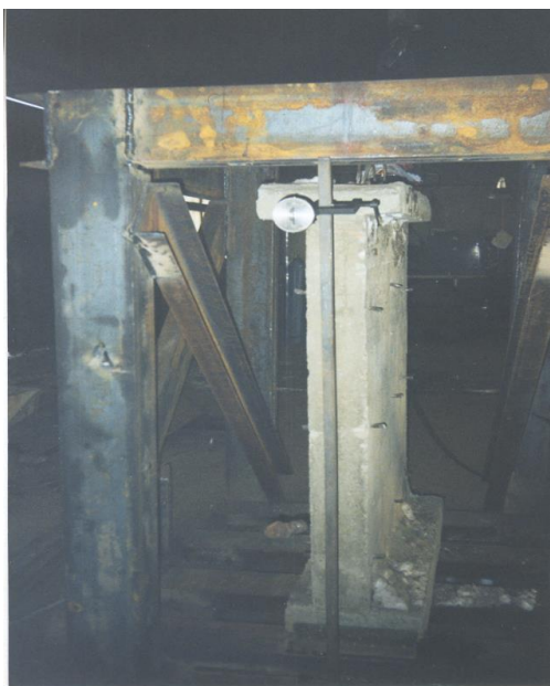
Рисунок 2.5 – Установка прогибомера при испытании однослойного фрагмента
