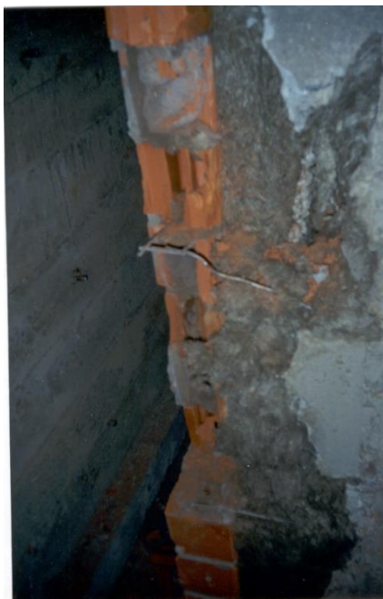
Рисунок 2.15 – Повреждения при одностороннем нагружении четырехслойного фрагмента (наружная кирпичная верста)
