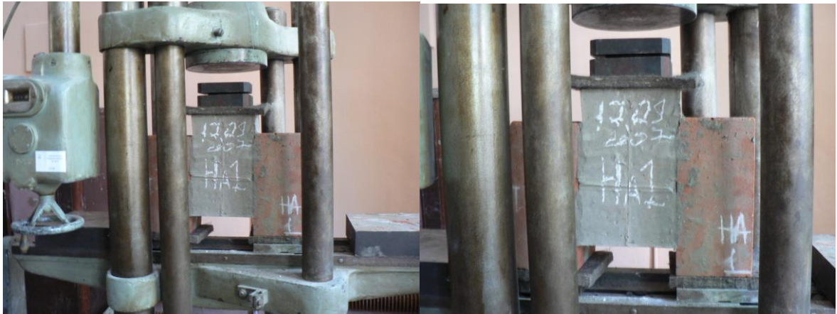
Рисунок 2.62 – Фрагмент для испытаний межслоевого касательного сцепления кирпичных и железобетонного слоев перед испытаниями
