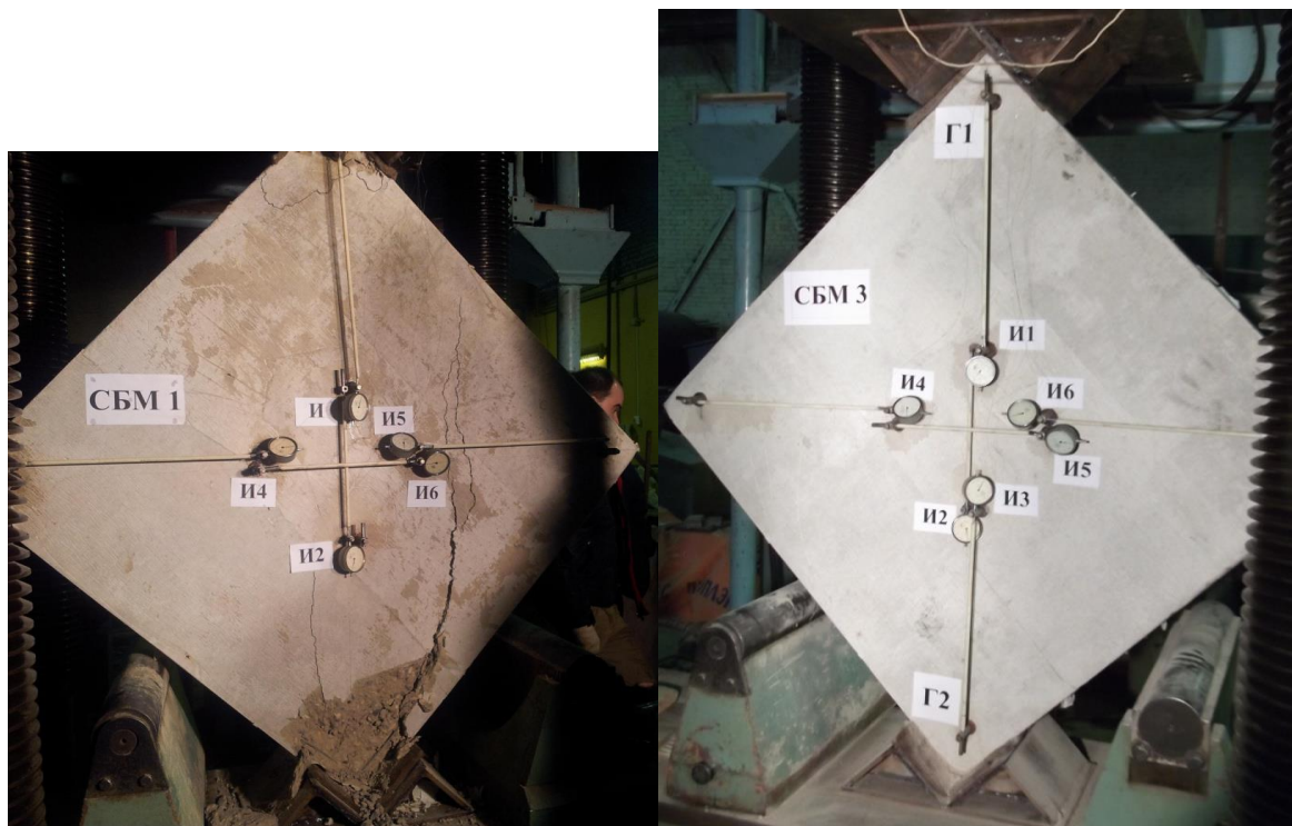
Рисунок 2.58 – Образец СБМ–1 после испытаний. Максимальная нагрузка 310 кН (слева). Испытание образца СБМ–3 на «перекос». Общий вид образца в прессе (справа)
