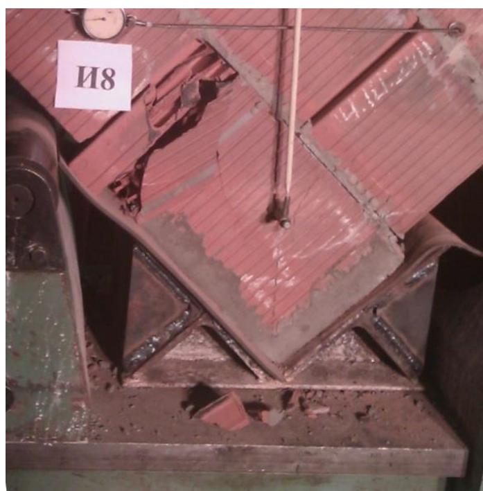
Рисунок 2.31 – Разрушение опорной зоны образца С3–250
