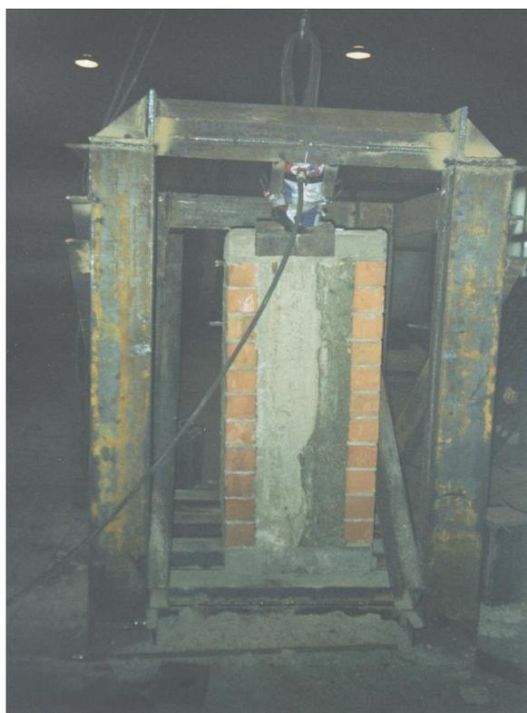
Рисунок 2.4 – Образец четырехслойной стены на испытательном стенде
