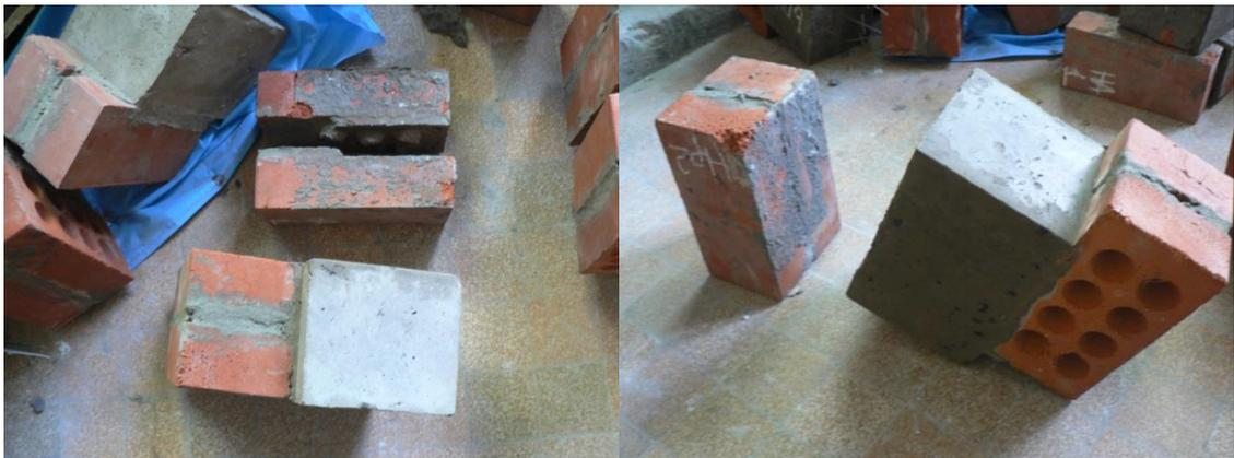
Рисунок 2.63 – Экспериментальный образец после испытаний
