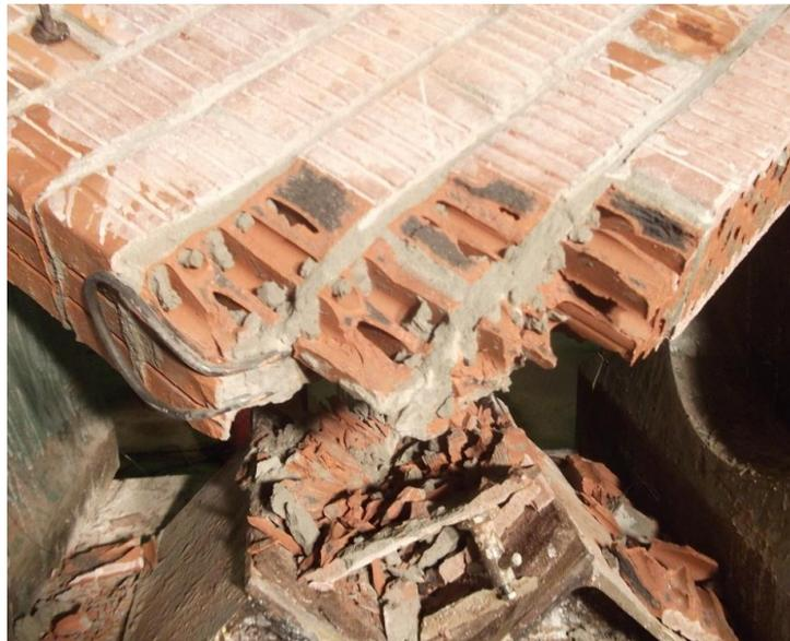
Рисунок 2.24 – Образец С2-1 после снятия с испытательной установки
