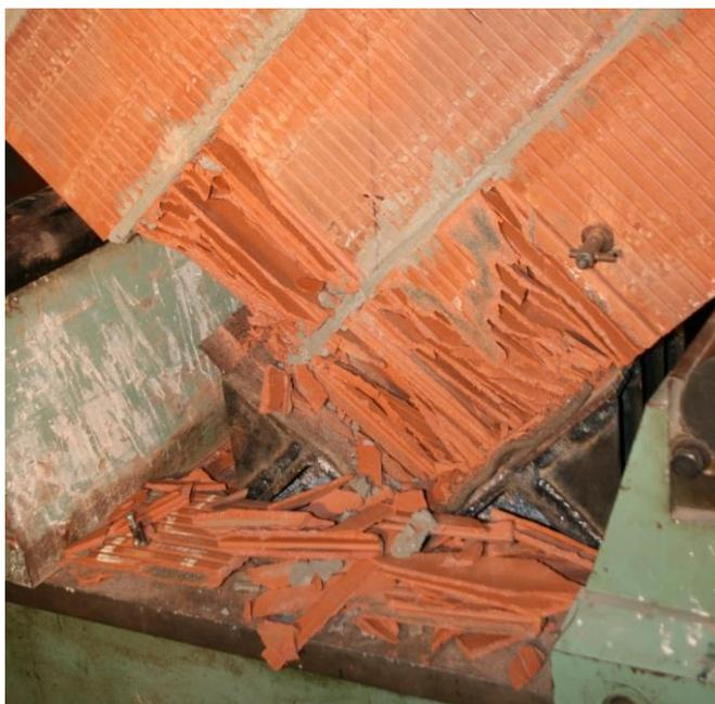
Рисунок 2.30 – Разрушение опорной зоны образца С2–250
