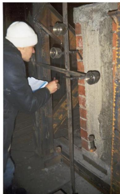
Рисунок 2.6 – Установка прогибомеров при испытании многослойных фрагментов
