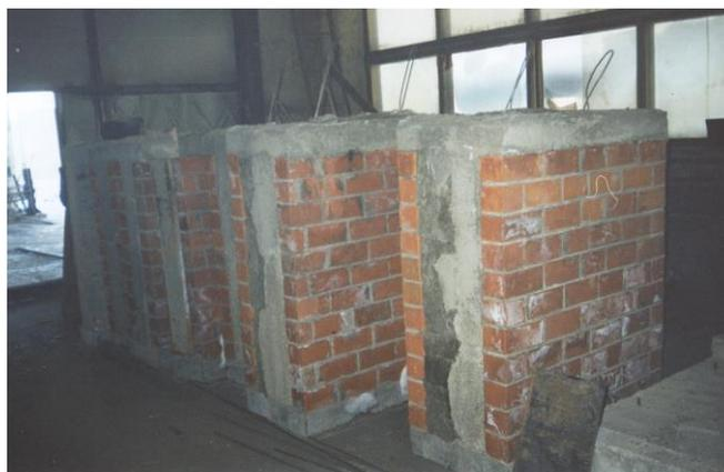
Рисунок 2.2 – Фрагменты трех- и четырехслойных стен перед испытаниями
