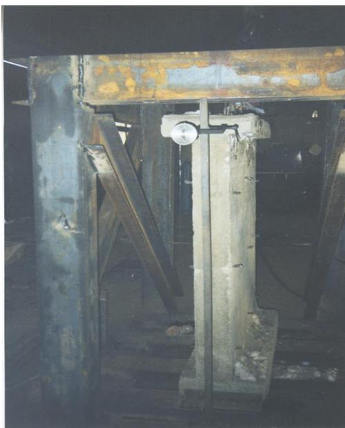
Рисунок 2.5 – Установка прогибомера при испытании однослойного фрагмента
