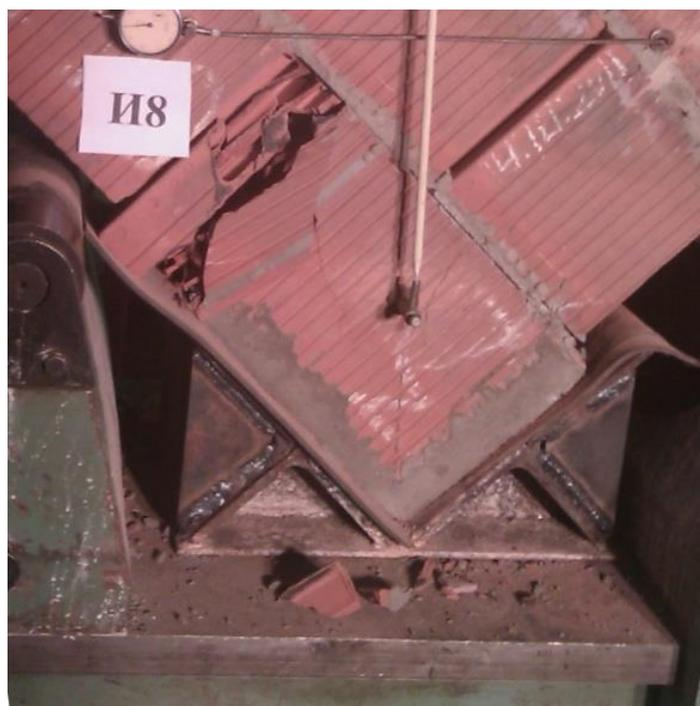
Рисунок 2.31 – Разрушение опорной зоны образца С3–250
