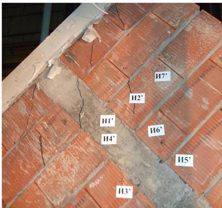
Рисунок 2.54 – Раскрытие трещин в образце ВК–2.  $N_p = 280$  кН
