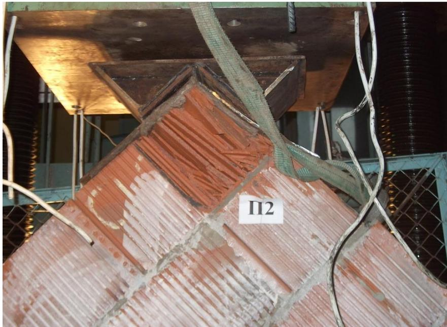
Рисунок 2.28 – Разрушение образца С1–250
