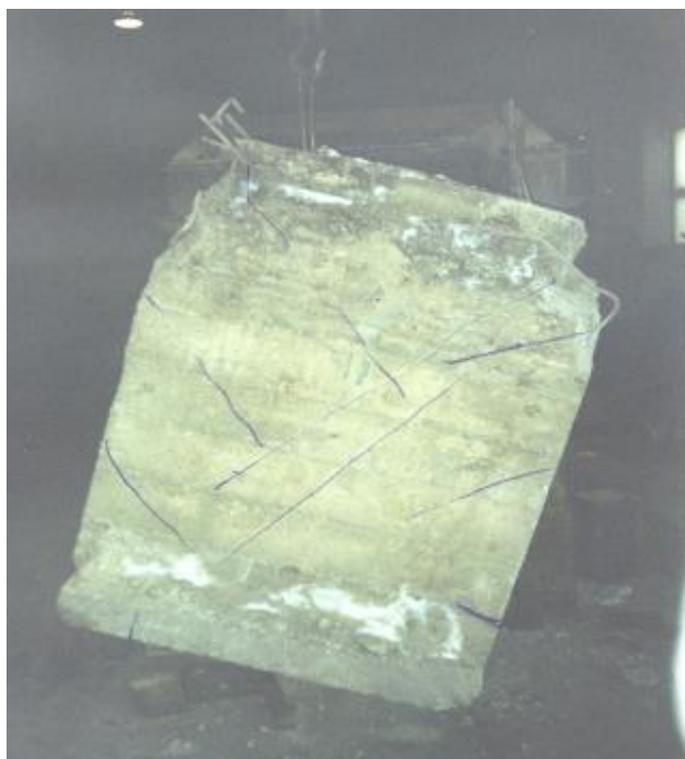
Рисунок 2.7 – Однослойный фрагмент стены после испытаний
