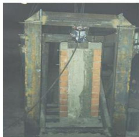
Рисунок 2 Фрагменты трех- и четырехслойных стен перед испытаниями
